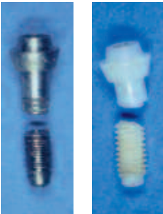
Abb. 44 und 45 Fraktur so genannter intramobiler Elemente, prothetische Aufbauteile des IMZ Implantatsystems (Fa. Friudent)
